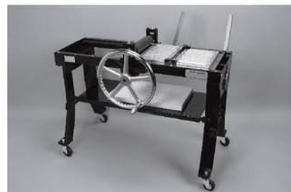
左近允が考案した点字活版印刷機(復元) 国立民族学博物館 所蔵
